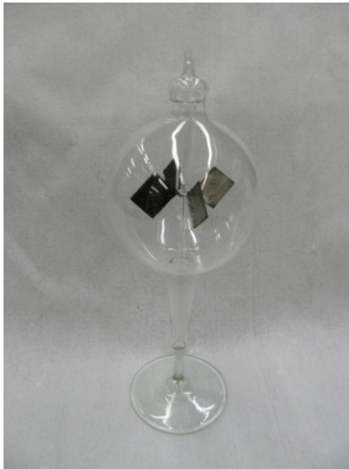
**Radiomètre de Crookes** : On supprime la lampe et on recouvre le radiomètre avec un couvercle plus froid que la température ambiante
