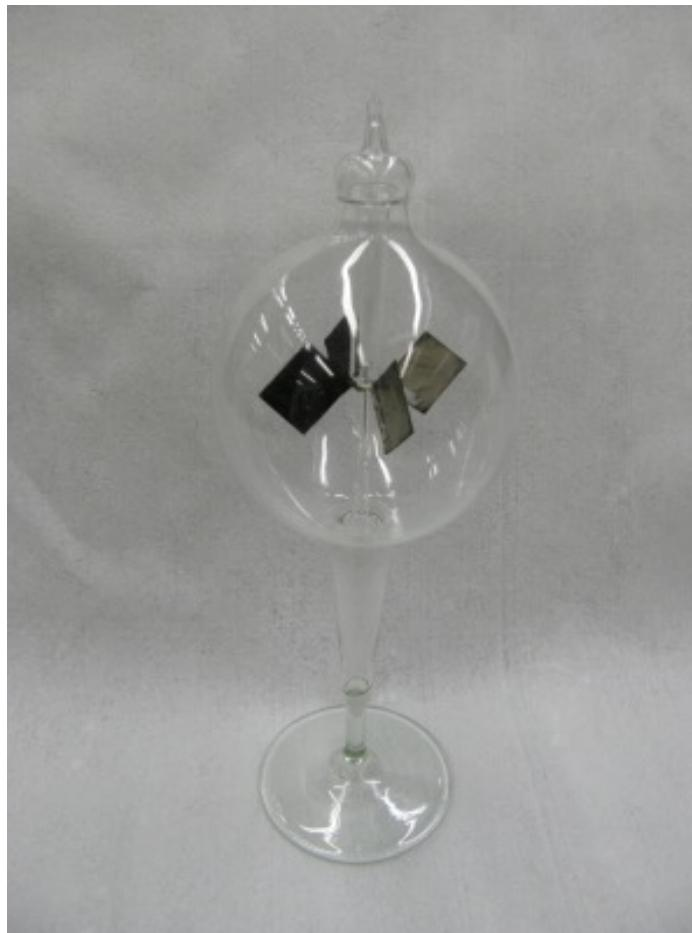
**Radiomètre de Crookes** : On supprime la lampe et on recouvre le radiomètre avec un couvercle plus chaud que la température ambiante
